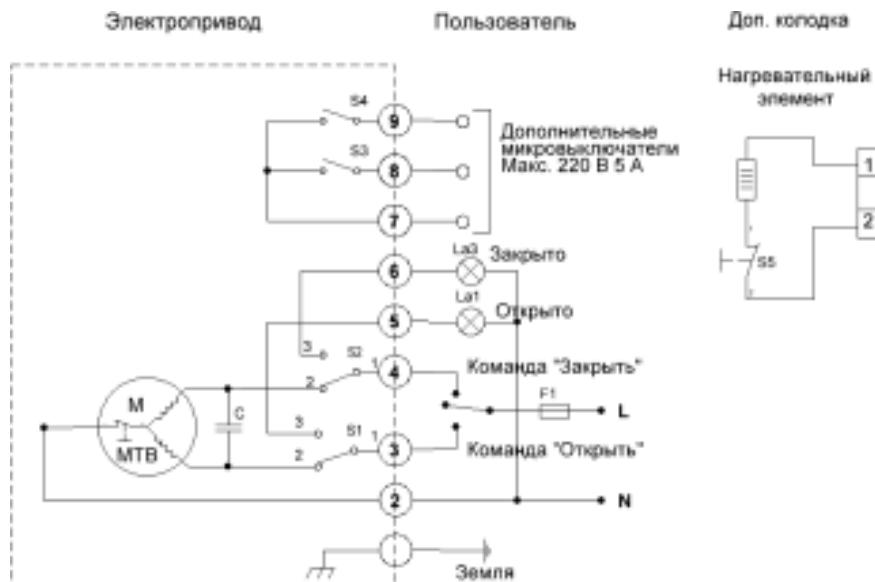
Рис. 1а Принципиальная электрическая схема подключения электропривода BENARMO ЭП-ЧМ к сети 220 В, 50 Гц (Исп. S01-стандартное, нагревательный элемент является опцией, на BENARMO ЭП-ЧМ 003 установка невозможна)
